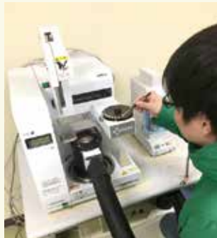
学内実験にて、すき昆布の乾燥特性を把握した（比熱解析、乾燥シミュレーションの様子）
